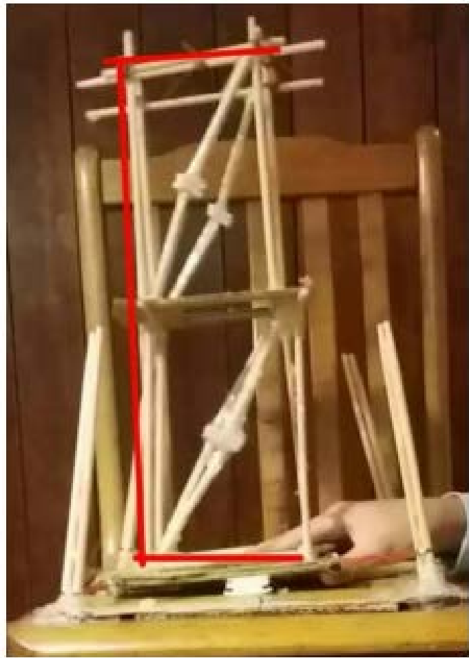
圖十，裝有制震壁的實驗
